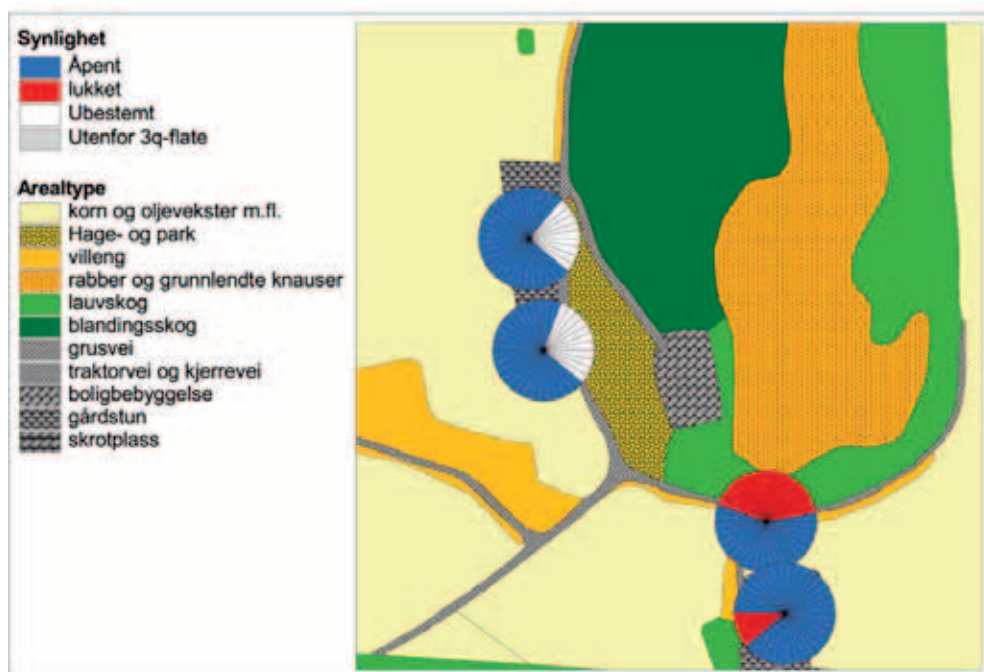
Figur 5: Visuell tilgjengelighet (synlighet) i 3Q-programmet beregnes som prosentandel av sektorer i en sirkel rundt kulturminnet som er åpne med hensyn på innhold av arealtype. Indikatoren måler grad av innsyn fra utenfor en sirkel på 25 m radius til kulturminnet i sentrum av sirkelen. Dette er illustrert i figuren for fire kulturminner; de blå sektorene er på åpne arealtyper, de hvite er på arealtyper som ikke kan defineres som enten åpen eller lukket, mens i de røde sektorene er innsyn til sentrum sperret av lukkede arealtyper (Stensgaard og Reid, 2007).
